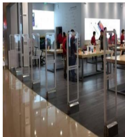
安装在车间、仓库、办公楼出入口，自动记录进出带有RFID标签的资产ID
